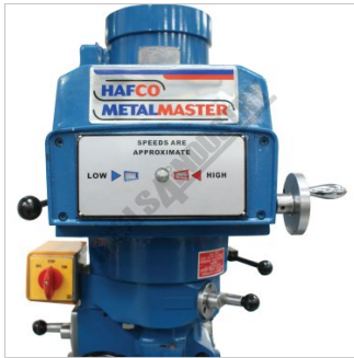
Variable Speed Head 70 3500rpm
